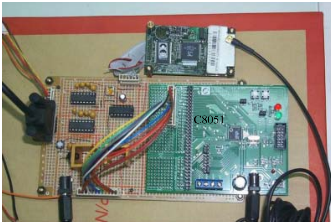
圖 5-4 C8051 單晶片及變壓電路。
