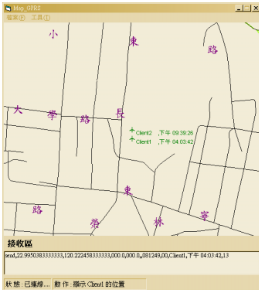
圖 5-14 Server 端程式(上半部視窗為電子地圖， 下半部視窗為收到之資料)。
